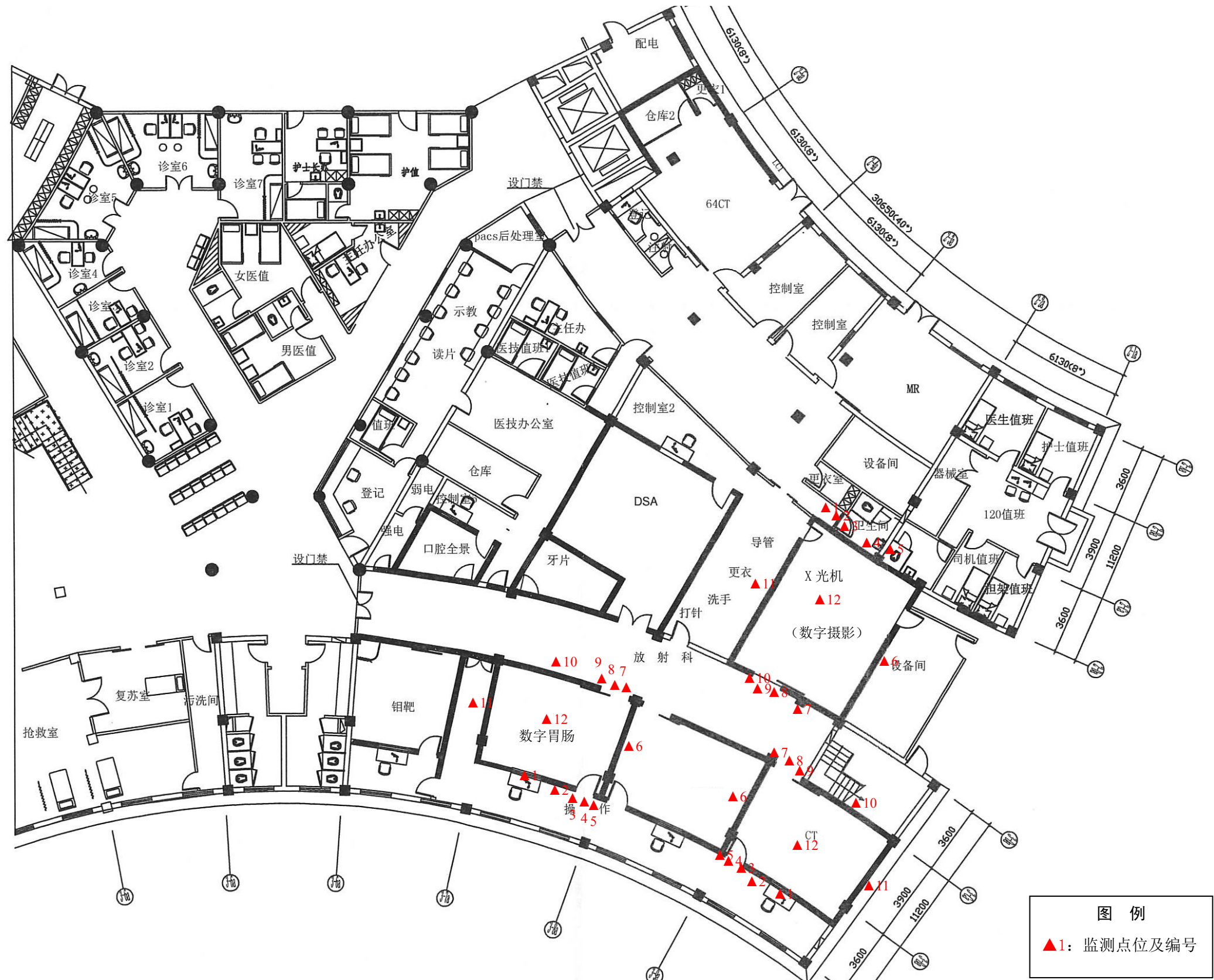
图 4-5 下沙院区 X 射线装置工作场所及周围环境辐射监测布点示意图
